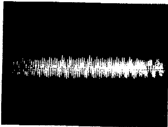
F : utilisation d'un câble protégé à la place du câble torsadé : le 1 er pic a disparu , même en présence de signal musical.
